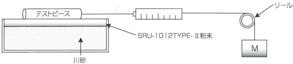
モーターにてリール先の糸を引っ張り、テストピースが動いた時のばねばかりにかかる荷重の最大値を測定する。
